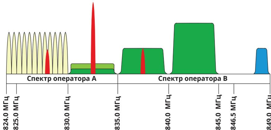
Рис. 9. Неисправные ретрансляторы могут блокировать лицензированную передачу
