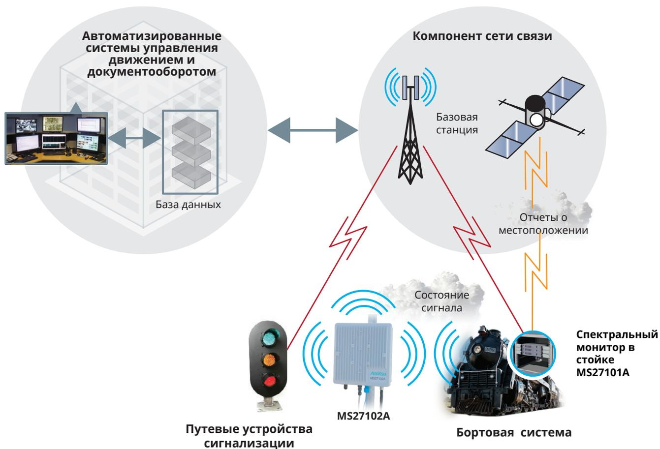
Рис. 1. Использование MS27101A в системе принудительного управления поездом
