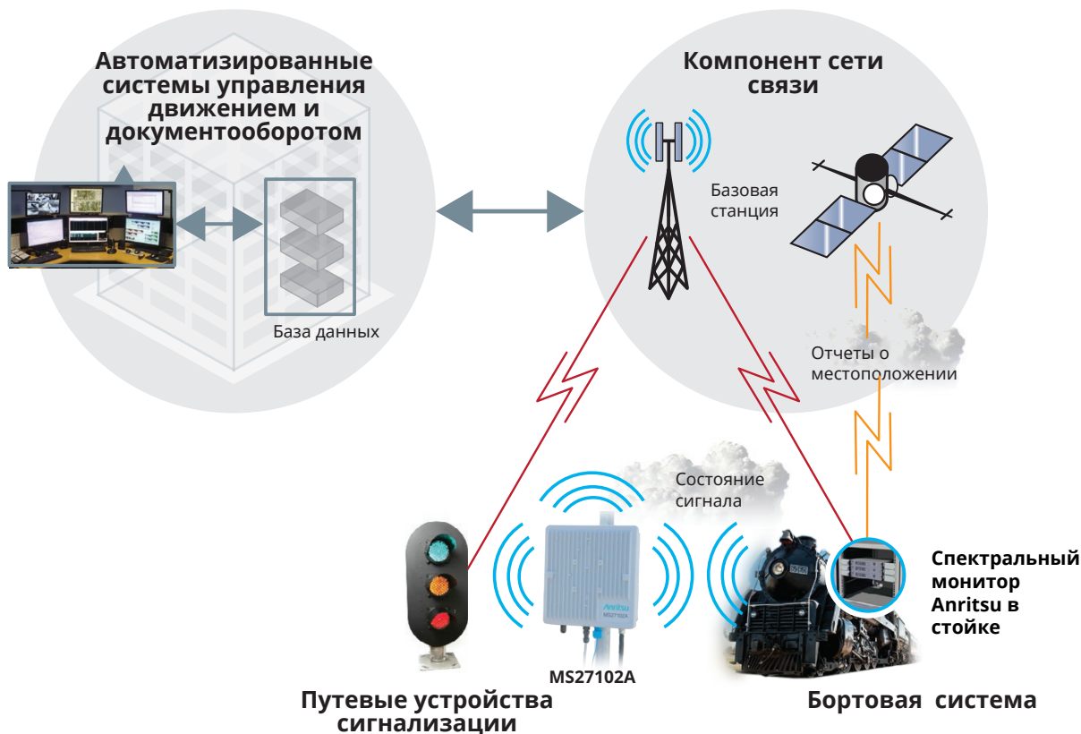
Рис. 1: Использование системы спектрального мониторинга для контроля частот РТС
